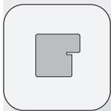
Massivholzkonstruktion (Schlitz/Zapfen), PA 73 mm, lamelliert und keilgezinkt, Decklage Furnier (bei Buche, Eiche, Ahorn)
