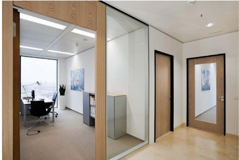
Links im Bild der Bürozugang mit Schallschutztür SD 42 dB,  $R_w,P$  in einer transparenten Systemtrennwand. Rechts daneben eine T30/RS Tür mit Oberfläche Eiche, transparent lackiert. Ganz rechts eine einflügelige T90 Tür mit großflächiger Verglasung.
