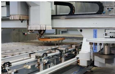
Mit Hilfe innovativer Produktionstechnologie kann Schörghuber Spezialtüren in großer Stückzahl und ebenso in Losgröße 1 schnell und in gleichbleibend hoher Qualität herstellen.
